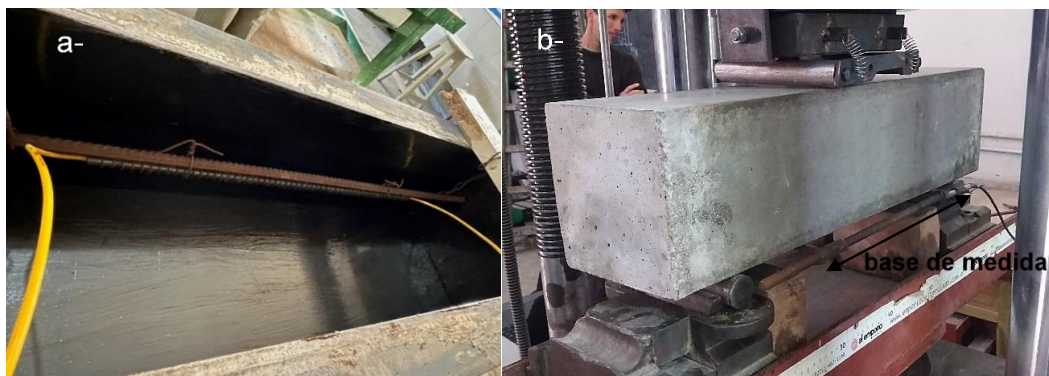
Figura 3. a- Ubicación de la FO en el molde antes de hormigonar. b- Ensayo de flexión a los tercios.
