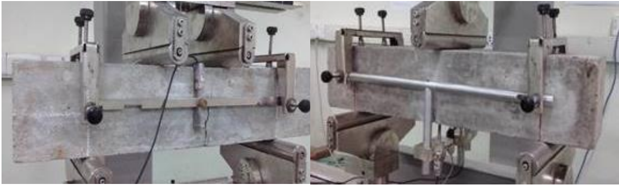
Figura 1. Ensayos de flexión sobre prismas de HRF, configuración según normas ASTM C1609 (izquierda) y EN 14651 (derecha).
