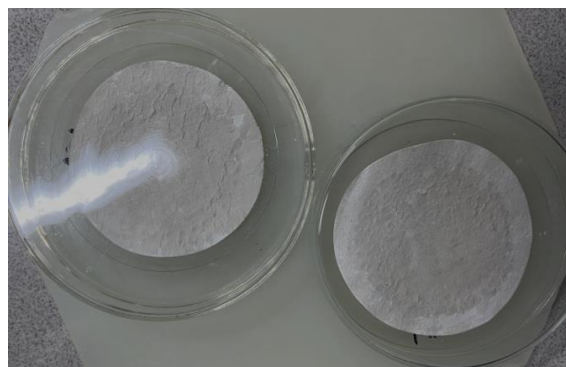
Figura 3. Residuo obtenido de la disolución con solución de EDTA+TEA+DEA.
