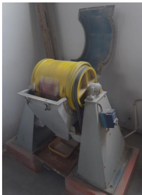
Figura 1. Proceso de molienda de la escoria de alto horno.
