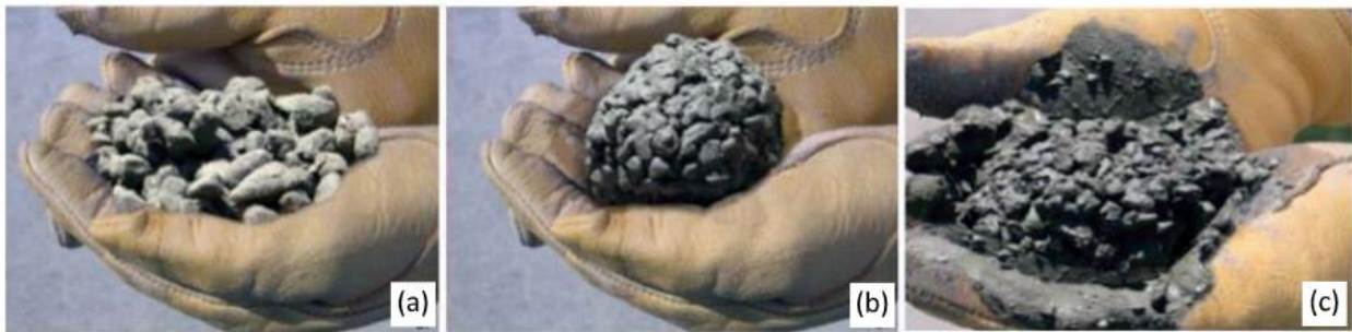
Figura 2. Ensayo de Hand-Squeeze. Muestras de hormigón drenante con diferentes contenidos de agua, formados en una bola: (a) muy poco contenido de agua, (b) cantidad adecuada de agua y (c) demasiado contenido de agua (adaptado de [23]).
