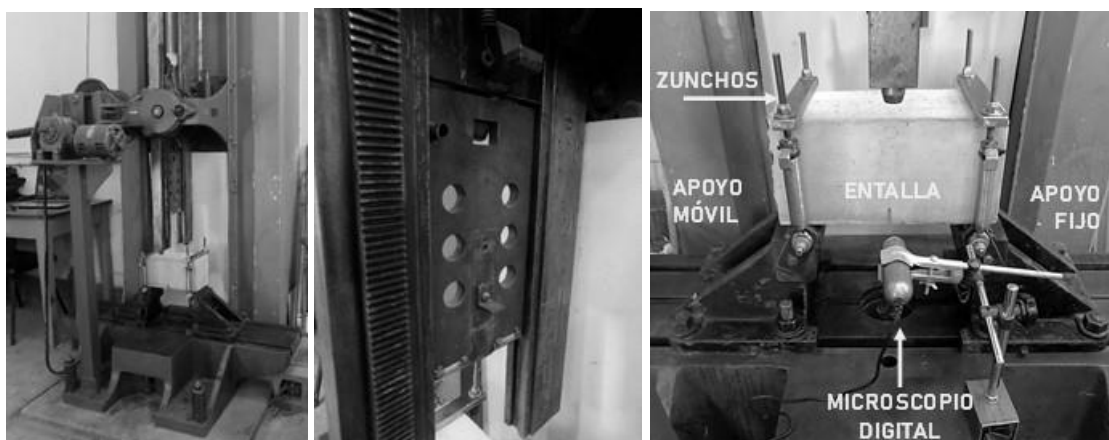
Figura 2. Izquierda: Configuración de ensayo de impactos crecientes, máquina de ensayo LEMIT. Centro: Proyectil de masa 5 kg. Derecha: Disposición de la probeta.
