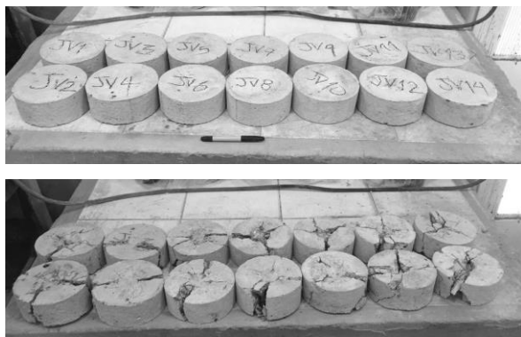
Figura 6. Modo de falla de las muestras ensayadas conforme al método del comité ACI-544.
