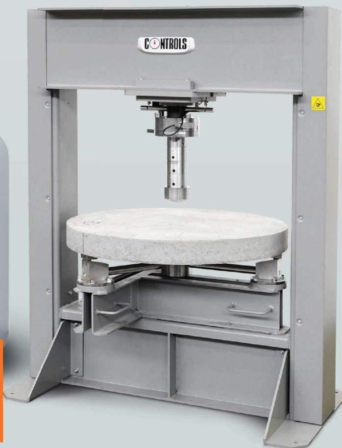
Realiza ensayos controlados por desplazamiento en vigas con hendidura, adoquines redondos o cuadrados, con el bastidor de flexión adecuado
