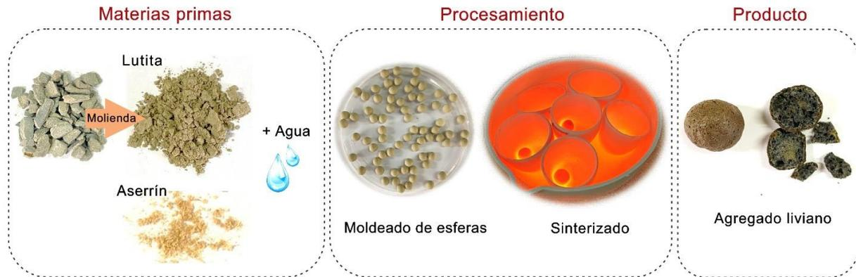
Figura 1. Diagrama del proceso de preparación de los agregados livianos.
