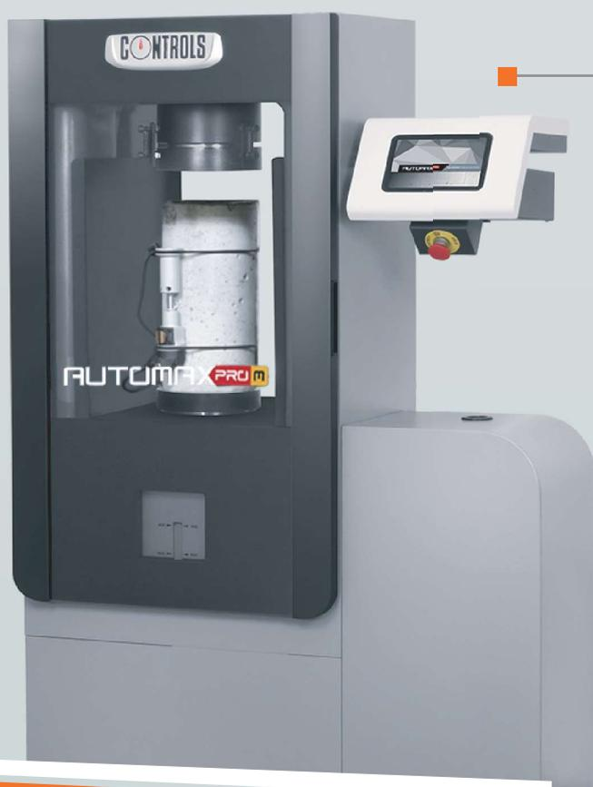
Ejecución automática del ensayo de Módulo Elástico de acuerdo con las principales normas internacionales y cálculo automático de los resultados del ensayo.
