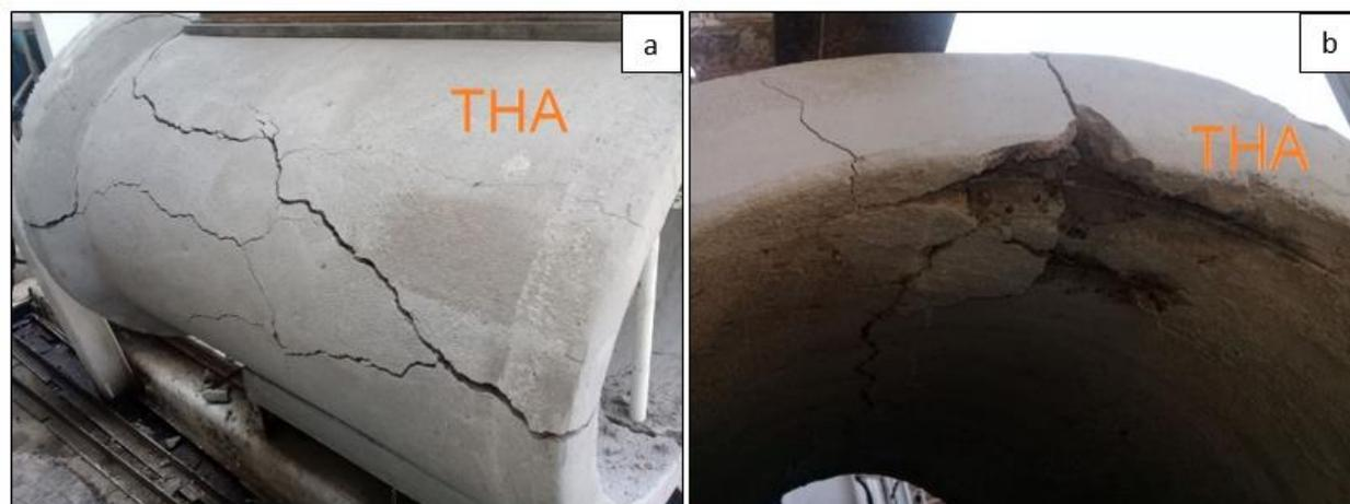
**Figura 5.** a) Patrón de fisuración longitudinal. b) Desprendimiento de hormigón en la clave de un THA.
